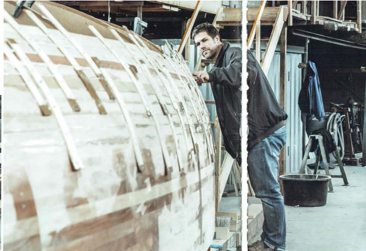
Wenn alle Planken befestigt sind, wird der Rumpf gespachtelt und geschliffen
